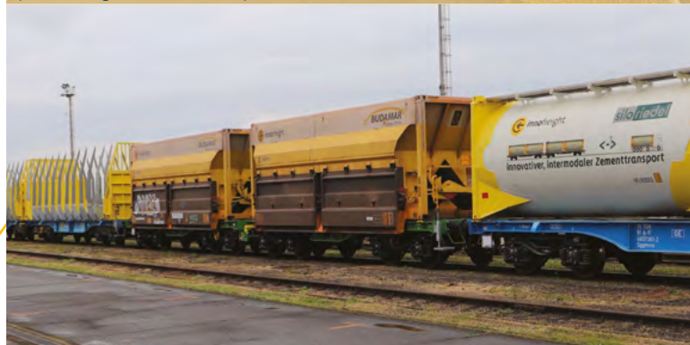
V TKD Dobrá boli predstavené viaceré typy špecializovaných nadstavieb na prepravu rôznych tovarov. Tieto vymeniteľné kontajnery sa uplatňujú v prepravách čoraz častejšie.
