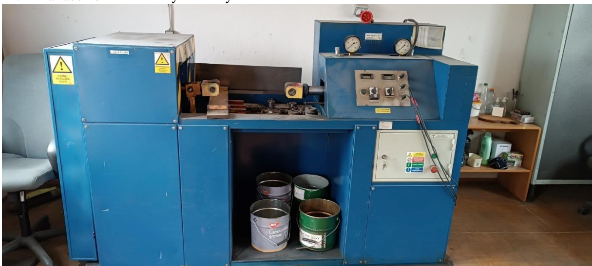
21. Zariadenie na skúšku hydraulických tlmičov
