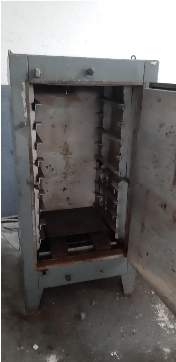
21. Zariadenie na skúšku hydraulických tlmičov
