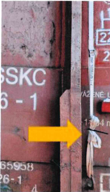
Obr. 14 Dvojitá slučka zaistená prepravcom pomocou poistnej nylonovej zipsovacej pásky. Stanica BA východ
