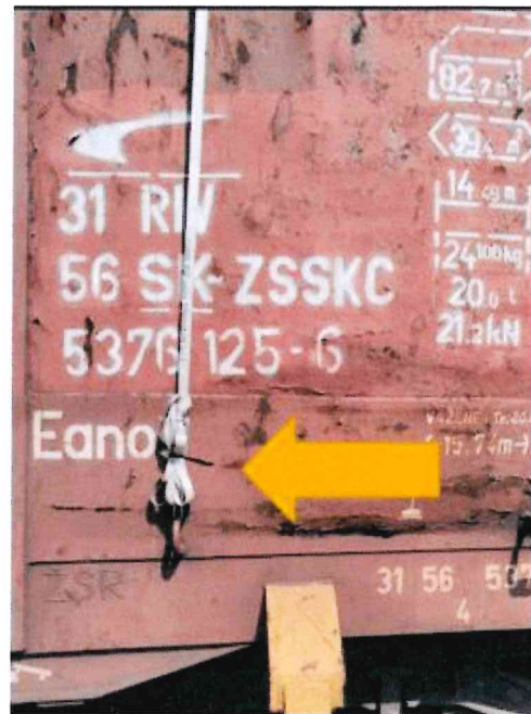
Obr. 15 Dvojitá slučka zaistená prepravcom pomocou nylonovej zipsovacej pásky. Stanica BA východ
